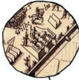
Afb 4 - 6 Overzichtkaart van de vestingstad Grave en detailopname van de stellingplaats met vlag. De afstand van de stelling tot de stadsmuur is 900 m. Op de stelling stonden drie en soms vier kanonnen half kartouw opgesteld zoals op bovenstaande tekening is te zien.
